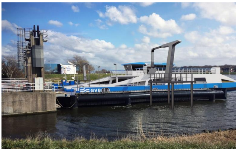
Laadpunt voor elektrisch aangedreven veerpont voor het Noordzeekanaal.
