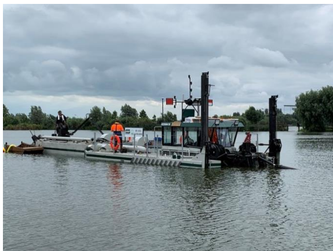
Elektrische baggerzuiger op de Langerse Plassen
