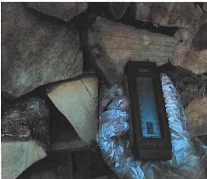
Foto 11: Hout opslagunit onder dak, rechts liggend in de achtertuin direct naast de openstaande tuindeuren; Vochtpercentage meting loofhout, essenhout, gemeten 15%.
