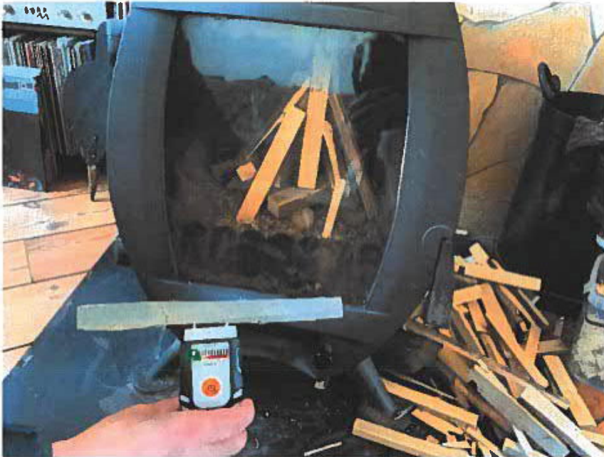
Foto 5 Houtkachel type invicta, , derde partij: Start aanmaken/aanzetten houtkachel met vuren aanmaakhout (naaldhout) met een gemeten vochtpercentage op het moment van stoken, van 9 tot 11%.
