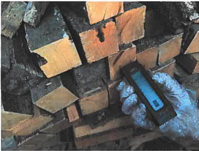
Foto 10: Hout opslagunit onder dak, rechts liggend in de achtertuin direct naast de openstaande tuindeuren; Vochtpercentage meting naaldhout 15%.
